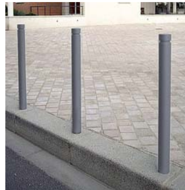
Potelet, fixe et amovible, 90cm, 9cm de diam, en métal, teinte gris RAL 9006 modèle Basic 1 de chez Concept Urbain, ou équivalent
