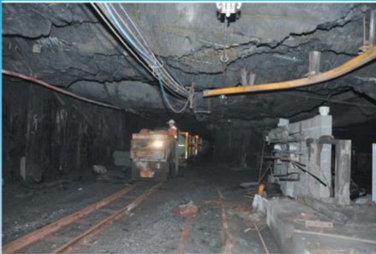
Fond de Monthibert 7, galeries d'exploitation à - 300 / - 450 m, travers banc d'accès aux chambres d'extraction, banc à rabattre méthode montante dans la couche. "Abatage" à la mine, préparation de la foration.
