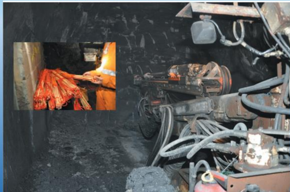
Fond de Monthibert 7, galeries d'exploitation à - 300 / - 450 m, travers banc d'accès aux chambres d'extraction, banc à rabattre méthode montante dans la couche. "Abatage" à la mine, préparation de la foration.
